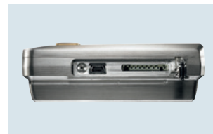
Seitlicher Anschluss von Mini-USB-Kabel und SD-Karte
